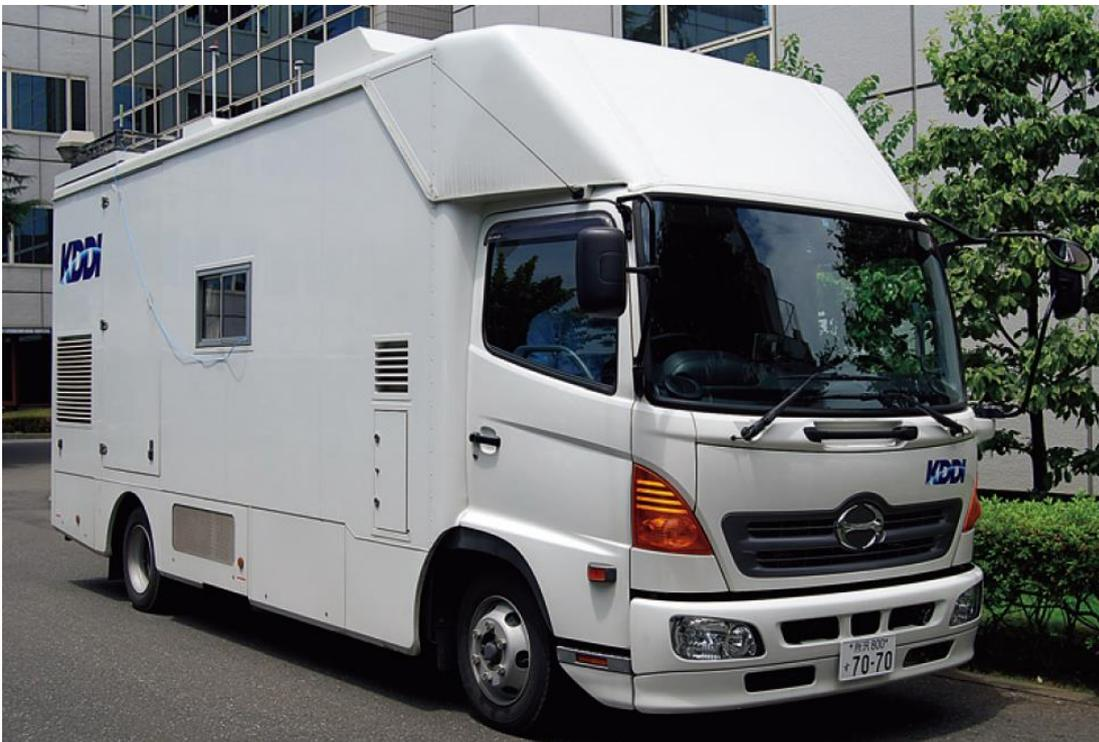
図 「IMT-Advanced」電測車
